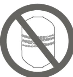
6. При подъеме корпуса используйте такелажную балку с гладкой поверхностью.
