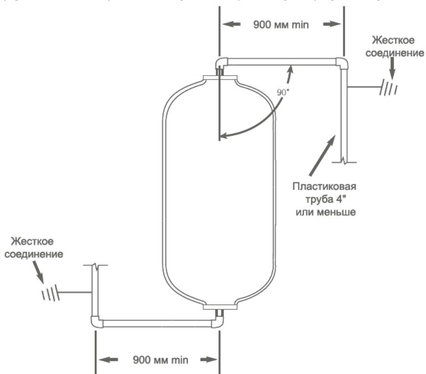
Данная схема применима для систем с рабочим давлением 150 psi. Если рабочее давление в установке ниже 150 psi, горизонтальное плечо трубы может быть меньше. Оно рассчитывается по следующей формуле:
