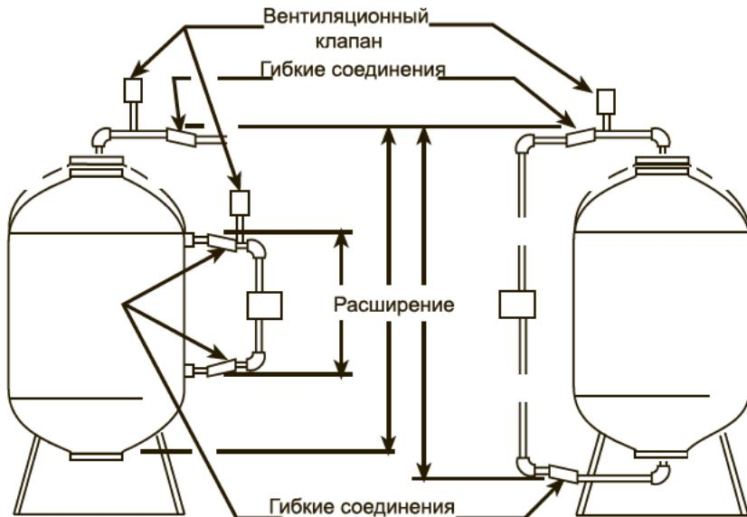
Для того чтобы уменьшить угловые нагрузки на трубопровод, вызванные изменением высоты корпуса, также можно применять схему обвязки, приведенную на рисунке внизу.
