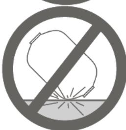
4. Никогда не роняйте стеклопластиковый корпус и не допускайте жестких ударов или трения корпуса о стены, перегородки, инструменты или оборудование.
