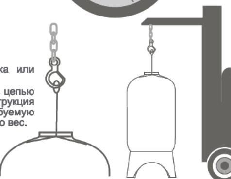
5. Поднимайте корпус с помощью подъемника или лебедки, как показано на рисунке.
