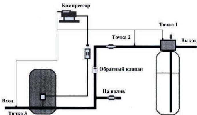
Рис.1 Варианты подачи воздуха в водопровод.
